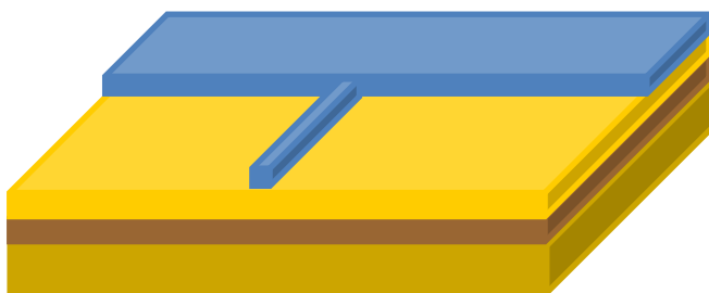
Рис.4. Результат технологической операции «Проявление фоторезиста»
